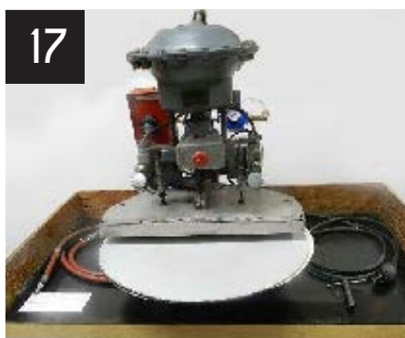
17 Presse chauffante à doublure
