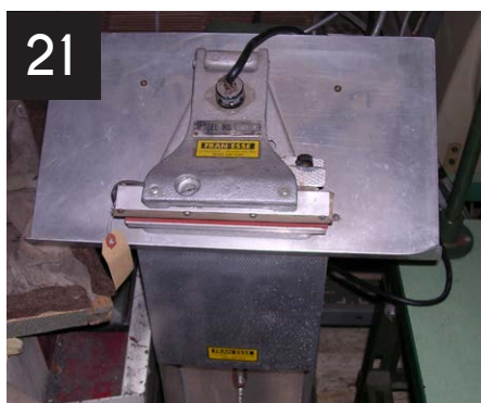
21 Machine à sceller les sacs FRANESSE 8R
